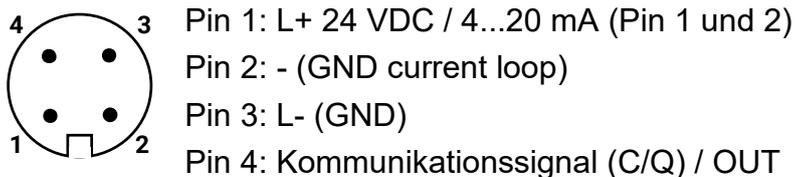
Die Pins dienen neben der IO-Link-Kommunikation auch zur Versorgung des Geräts.
