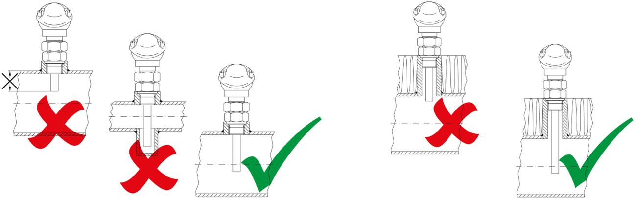
Die Messstelle muss sich in der Mitte der Rohrleitung befinden.
